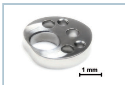
4 Links: Werkstück Herz für das Uhrenmodell Ingenieur der Firma IWC, Schaffhausen. Rechts: Pellaton-Aufzug mit Herz
