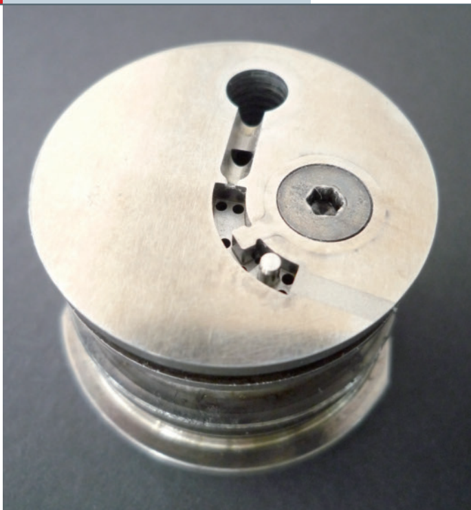
3 Bei der Bearbeitung eines Formeinsatzes für Spritzwerkzeuge konnte mittels MBS die Oberflächenrauheit, Geometrie und Durchmesser Genauigkeit einer 0,8-mm-Bohrung verbessert werden
