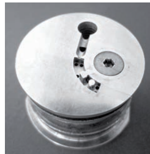
Spritzwerkzeugeinsatz, \varnothing 0.715 mm
