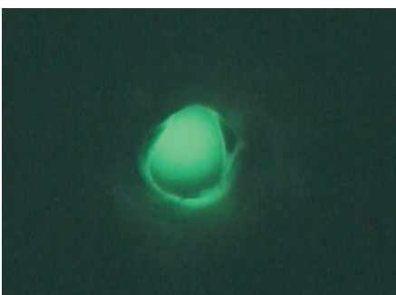
Abb. 5 Inkjetdüsen linkes Bild Laserbohrung mit \varnothing ca. 70 µm; rechtes Bild nach Bearbeitung mittels MBS \varnothing 150 µm
