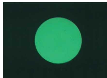
Abb. 5 Inkjetdüsen linkes Bild Laserbohrung mit \varnothing ca. 70 µm; rechtes Bild nach Bearbeitung mittels MBS \varnothing 150 µm
