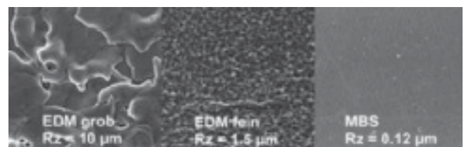
500-fache Vergrößerung einer Oberfläche von einer erodierten Bohrung in Stahl mit einem Rauheitswert Rz von 10 µm (links, groberodiert) respektive 1,5 µm (Mitte, feinerodiert) und einer mittels MBS optimierten Oberfläche mit einem Rz von 0,12 µm (rechts).
