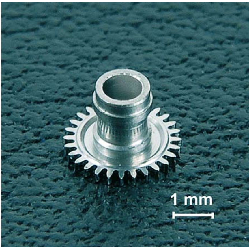
Bild 4: Uhrenzahnradchen aus gehärtetem Stahl, welches durch Drehen hergestellt wurde. Um eine Durchmesser-toleranz von 2 µm sowie eine Oberflächengüte von R_z = 0,2 \mu\text{m} einhalten zu können ist eine Nachbearbeitung mittels MBS Prozess erforderlich
