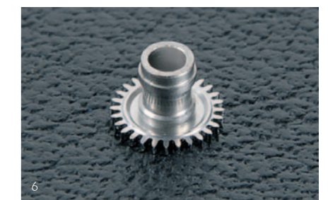
1. - 3.) Vue intérieure de la machine UniBore 800 4.) Molette de découpe (pour verre): diamètre de perçage 1,51 mm 5.) Géométrie d'une pièce typique 6.) Roue dentée pour l'horlogerie: diamètre de perçage 1,00 mm 7.) Outillage de coupe avec grains liés
