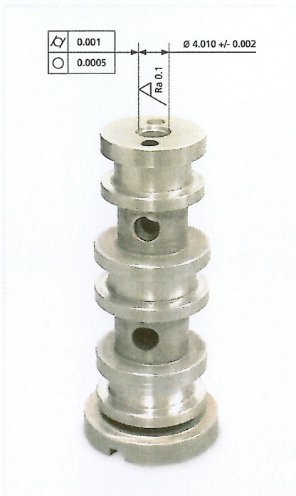
4 Die hohen Genauigkeitsanforderungen beim Bearbeiten dieser Schieberhülse mit Querbohrungen für hydraulische Anwendungen erfüllte das MBS problemlos (© Microcut)
