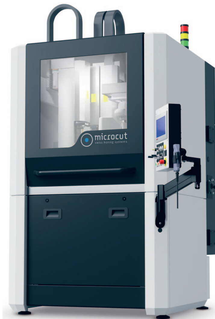
Bild 1. Die neue Honmaschinen-genera-tion von Microcut ist auf Bohrungen mit Ø 0,25 bis 16 mm und hohen Anforderungen an die Qualität ausgelegt
